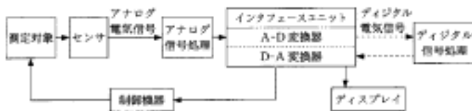
図4.8 計測システムにおける信号の流れ
