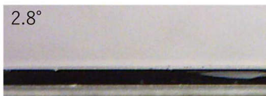
H 2 プラズマ曝露後の h-BN膜の接触角 (1-ブロモナフタレン)
