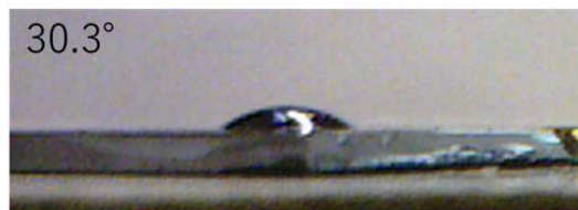
H 2 プラズマ曝露後の h-BN膜の接触角 (水)
